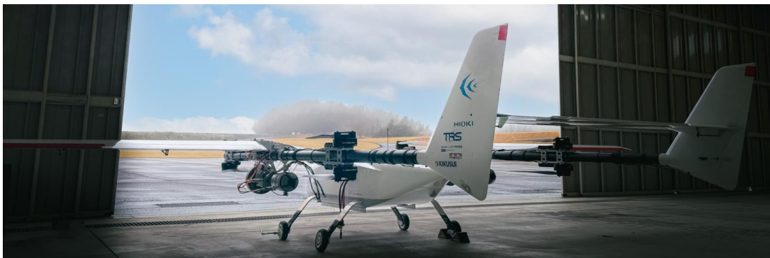
国産電動垂直離着陸型無人航空機「Dr-One(ディーアールワン)」試作 1 号機
